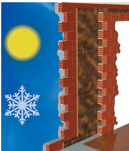
Figura 2: **Solución constructiva. Instalación de PANEL PLUS (TP 138) sobre el trasdós de una hoja de fábrica y cierre posterior mediante una segunda hoja**
