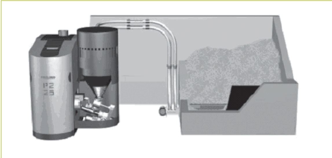
Figura 9. Instalación de una caldera de pellet con extractor neumático
